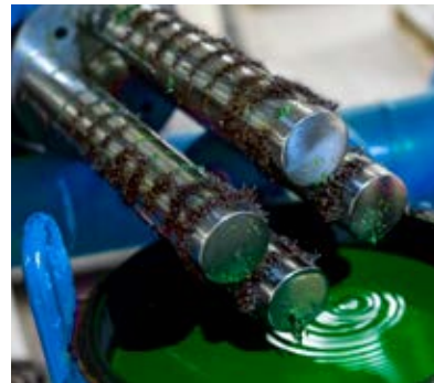
Magnetyczna wkładka w filtrze mechanicznym skutecznie usuwa pozostałości magnezytu z wody obiegowej.
