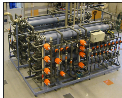
Gminna stacja uzdatniania wody pitnej o wydajności 48 m³/h. Układ zbudowany jest z dwóch jednostek NF 03-24, filtra wstępnego i automatycznej jednostki czyszczącej. Zastosowanie: częściowe odsalanie wody podziemnej
